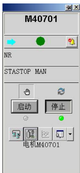
图 4.7.4 单 DI 单 DO 泵机系统面板
