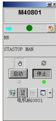
图 4.8.4.1 双 DI 单 DO 泵机系统面板
