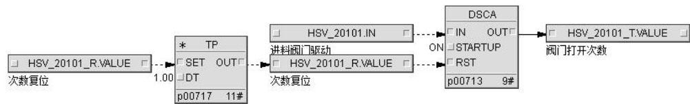
图 2.1.3.阀门打开次数程序搭建
