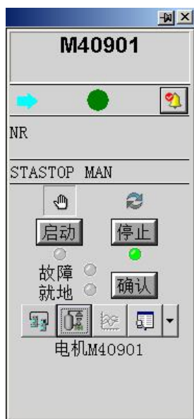
图 4.9.4.1 双 DI 双 DO 泵机系统面板
