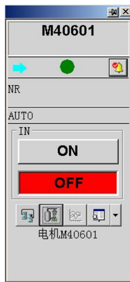
图 4.6.4.1 单 DO 停泵系统面板
