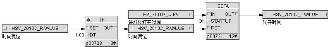
图 2.2.3 反应釜进料时间统计程序搭建
